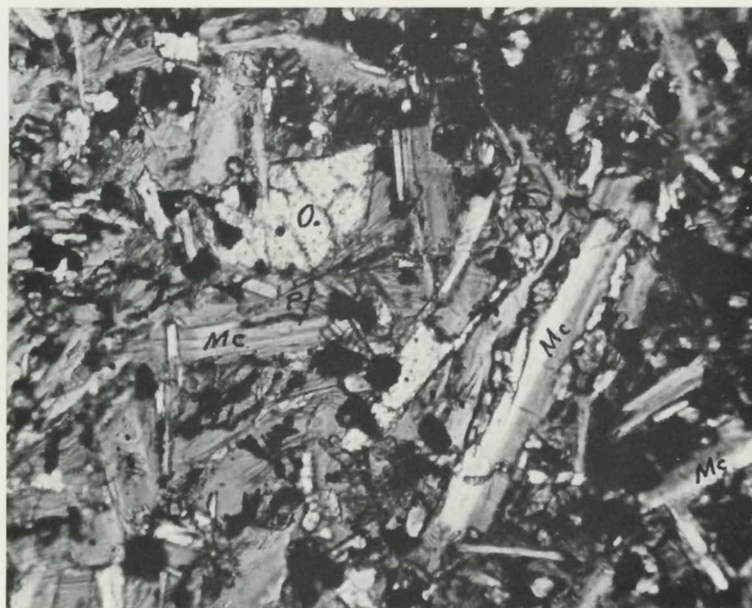
PHOTO 48. — Lame E 165. Gross. : 485×. (Nicols croisés.) O : olivine; Mc : microlites de labrador.
